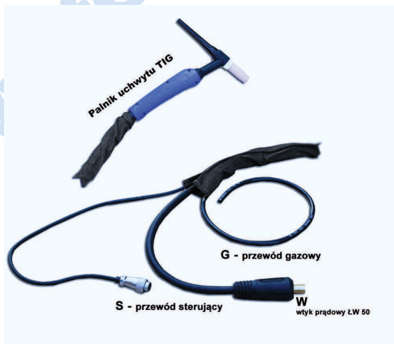
Rys. 7 Uchwyt TIG 26, chłodzony gazem – schemat
